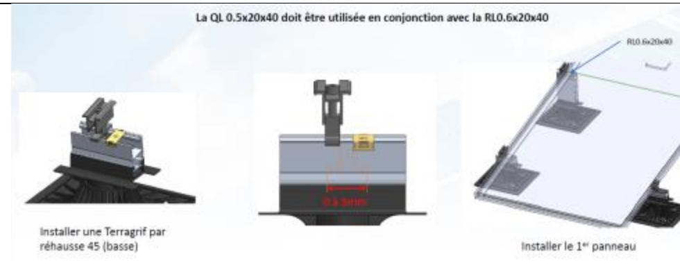
Système de mise à la terre Terragrif de Mobasolar (QL0.5x20x40 + RL0.6x20x40) des modules et rehausse aluminium
