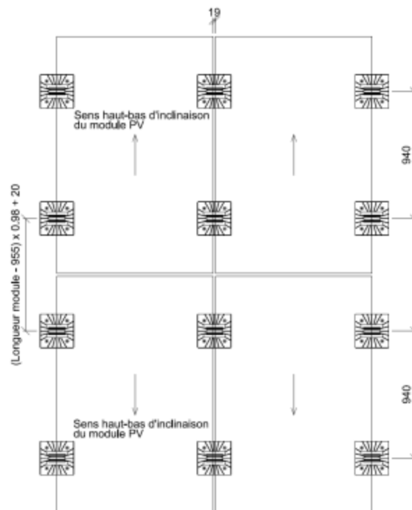
Figure 33 : Implantation des plots SOPRASOLAR FIX EVO avec modules photovoltaïques en inclinaison double shed – rehausse polymère
