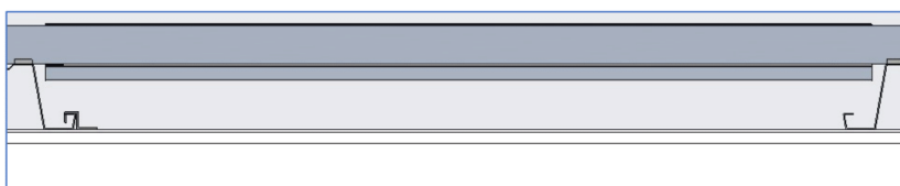
Figure 17 : ajustement latéral de la gouttière inter-module
